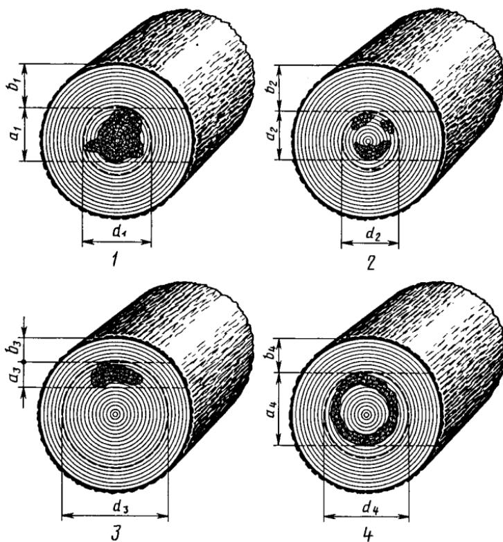
1 — зона поражения в виде массивного центрального пятна; 2 — зона поражения в виде нескольких пятен, расположенных в центре; 3 — зона поражения в виде одиночного эксцентрично расположенного пятна; 4 — зона поражения в виде кольца
