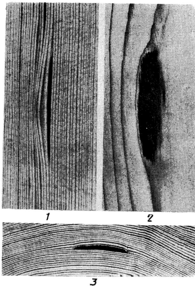
1 — радиальный разрез; 2 — тангенциальный разрез; 3 — торцовый разрез
